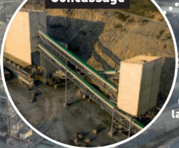
Le concassage permet de réduire de façon progressive la taille des matériaux.
